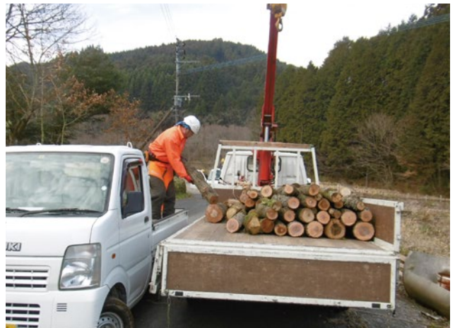
2tトラックロング(右)であれば4m材が運搬できます
