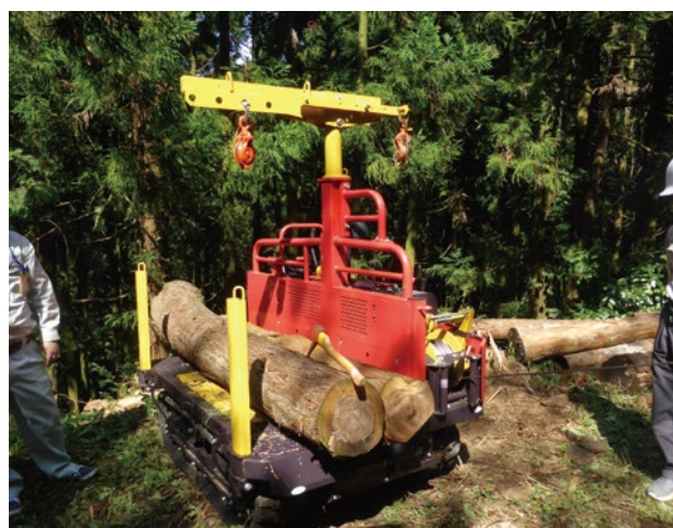
安全のため林内作業車を固定します
