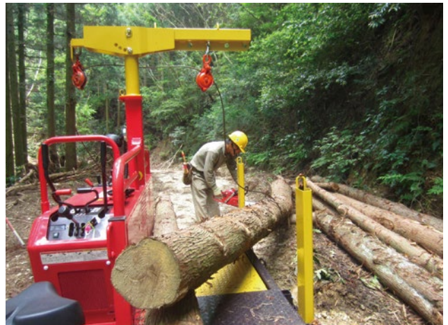
林内作業車への積込作業(ウインチも使用可)
