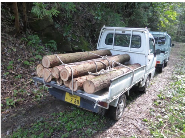
軽トラックによる材の運搬 (荷崩れに注意)
